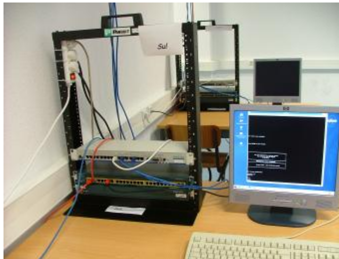
Fig. 1. Fotografia de uma bancada do laboratório de Complementos de Redes de Computadores constituída por várias estações de trabalho com duas interfaces ethernet , 1 hub , 1 switch Cisco 2950 e 1 router Cisco 2600 com interfaces ethernet e 4 interfaces série.
